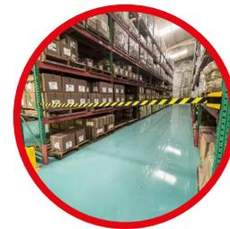
Se coloca en paredes y partes metálicas, tiene en su interior una cinta de poliéster con una punta magnética que se usa para restringir áreas.
